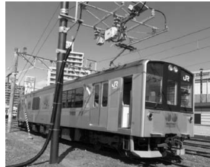
充電用架線および試験状況
