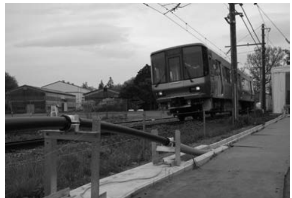
超電導ケーブルを用いた車両走行実験
