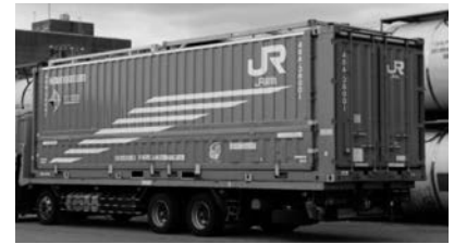
写真-2 モーダルシフトに有効な31フィートコンテナ
